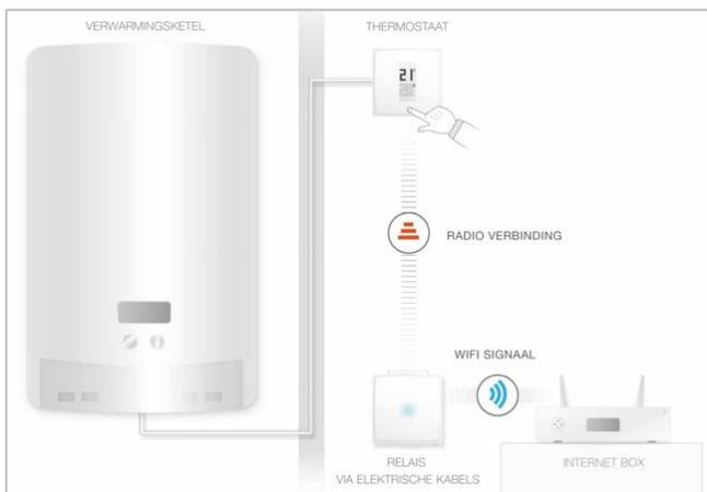
Le relais assure la connexion Wi-Fi à internet et le contrôle à distance depuis l'application Netatmo (smartphone, tablette, webapp).
