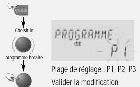
Fig.1.14 : Réglage du programme-horaire
