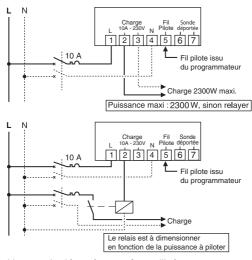
Une sonde déportée peut être utilisée. (10 KOhms à 25°C)
