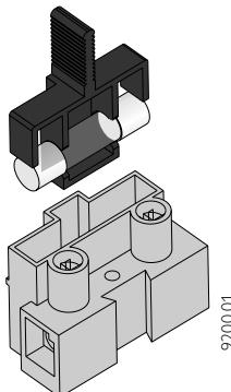
Voor vervanging van deze zekering, de bovenste houder; waarin de zekering vast zit, uittrekken.
