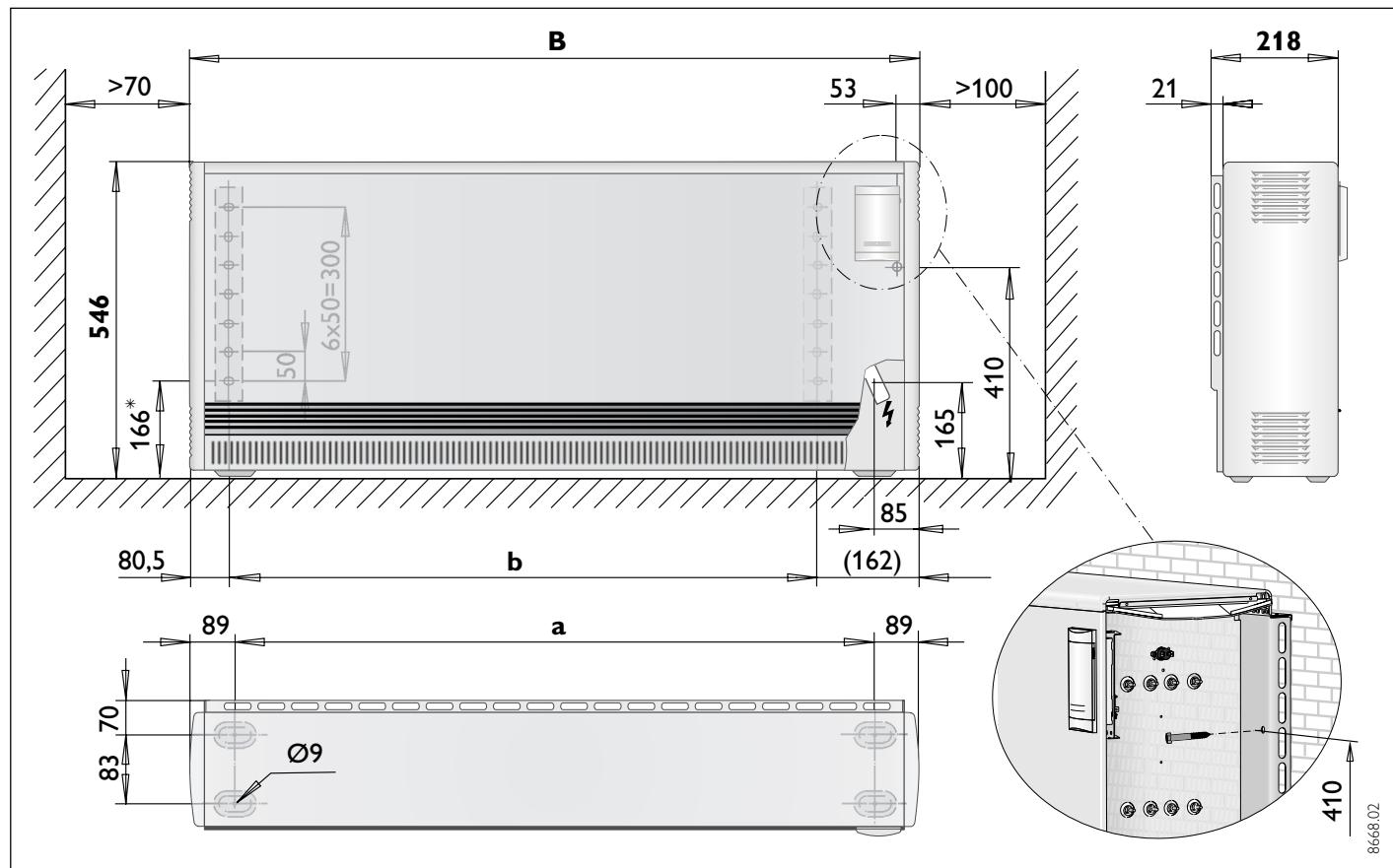
\* Montaje con un hueco con respecto al suelo, ver Pos. 2.4.2 "Fijación del aparado no apoyado sobre el suelo mediante soportes murales"
