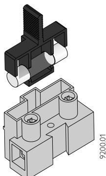
Para sustituirlo hay que separar la parte superior, que lleva el fusible, del zócalo.
