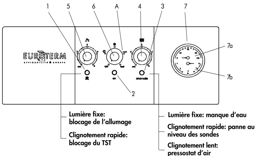
Lors du blocage de la chaudière, restaurer les conditions de départ en actionnant le sélecteur **6** jusqu'à la position de réarmement **A**.
