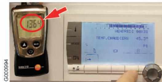
**⚠ Important: La pression de contrôle ne peut être mesurée que pendant la période de post-fonctionnement du ventilateur au moment de quitter le mode ramonage PMAX lorsque le brûleur n'est plus en fonctionnement.**
