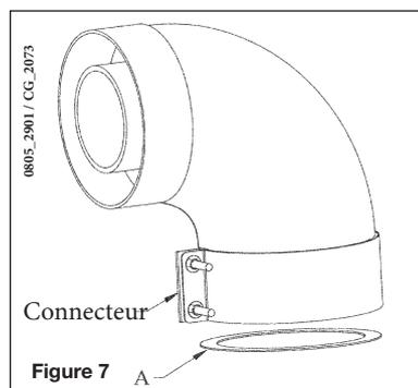
L'extrémité du conduit ressort à l'extérieur du bâtiment et doit dépasser la maçonnerie pour permettre l'installation de la rosace en aluminium et de son scellement et éviter toute infiltration d'eau. La pente minimum vers l'extérieur de ces conduits doit être de 1 cm par mètre de longueur.
