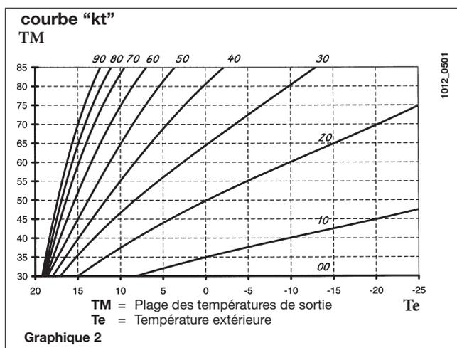
Le faisceau de câbles raccordé à la carte de contrôle comprend deux câbles ROUGES munis de cosses faston. Raccorder la sonde extérieure à ces deux câbles. Après la connexion de la sonde, les touches +/- IIIII permettent de modifier la courbe « kt » (Graphique 1).
