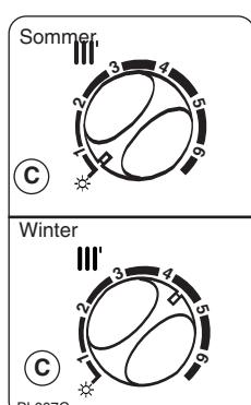
Belassen Sie den Schalterknopf "C" auf Position "", ist das Heizgerät auf **Sommerbetrieb** eingestellt. Das Symbol leuchtet auf, gemäß dieser eingestellten Betriebsweise.
