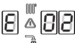
Im Falle einer Störung **E 02** vergewissern Sie sich bitte anhand des Hydrometers, dass der Anlagedruck 1 bar beträgt, bevor Sie den Kundendienst anfordern. Ggf. ist der Druck zu ergänzen. Öffnen Sie hierzu den unter dem Heizkessel befindlichen Füllhahn. Abschließend schalten Sie das Gerät über den ON/OFF-Schalter „A“ aus und wieder ein. Sollte ein solcher Druckabfall in der Anlage häufiger auftreten, dann lassen Sie die Anlage durch einen Klempner auf eventuelle Lecks überprüfen.
