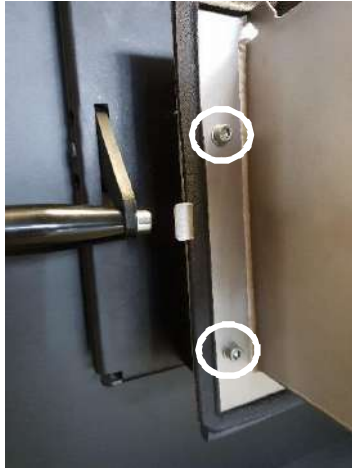
Vis de fixation brûleur sur porte avant.
