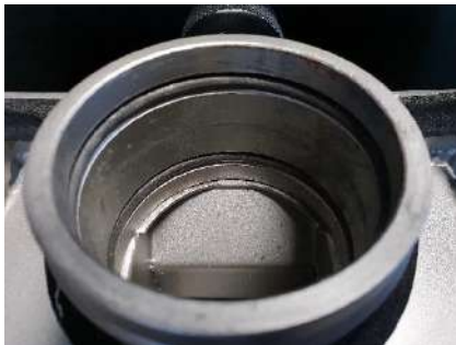
Attention aux joints toriques dans le cylindre.
