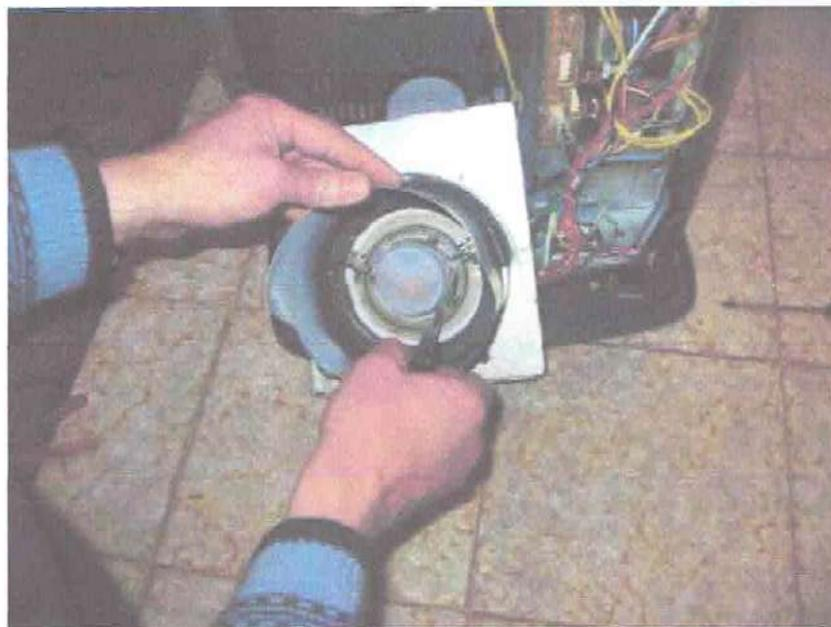
**-déposer le brûleur délicatement, et le diffuseur placé à sa partie inférieure,**
