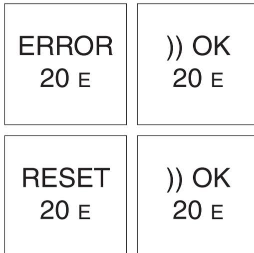
Dans ces conditions le réarmement doit se faire via la touche **RESET** se trouvant sur la chaudière (figure suivante).
