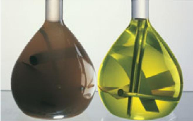
Eau non traitée, formation de boues métalliques dans le circuit polymatériaux (acier, fonte, cuivre, laiton, aluminium, polyéthylène).
