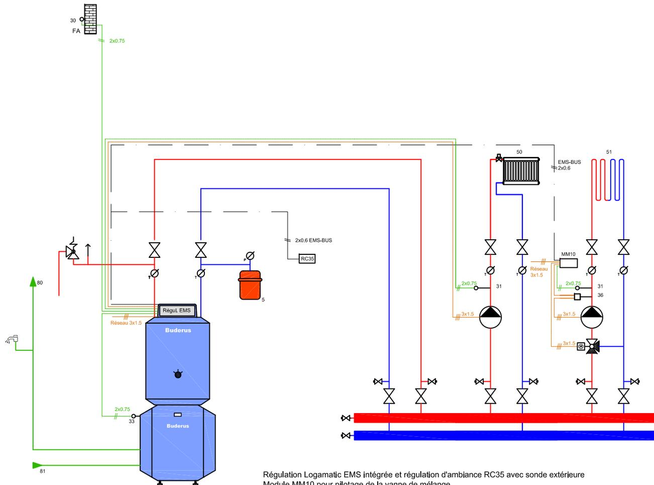
Régulation Logamatic EMS intégrée et régulation d'ambiance RC35 avec sonde extérieure
