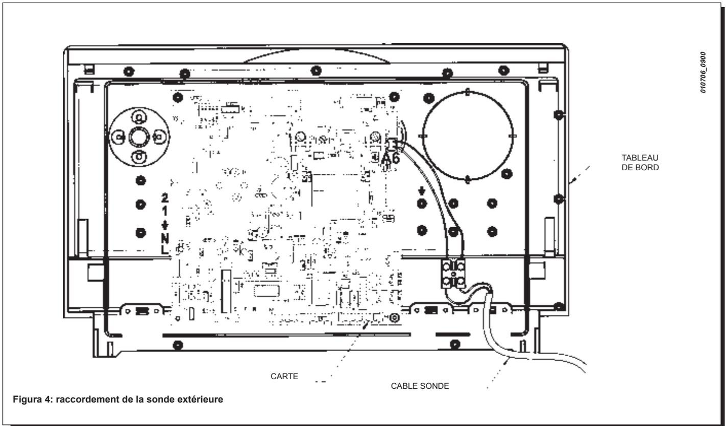
Le dispositif de régulation de la température du circuit de chauffage a pour fonction de régler le coefficient de déperdition Kt, la sonde extérieure étant connectée.
