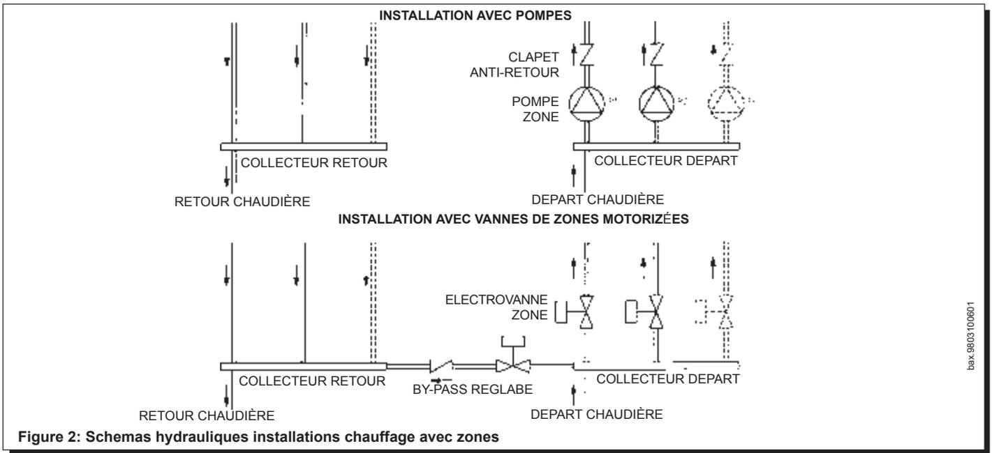
Figure 2: Schemas hydrauliques installations chauffage avec zones
